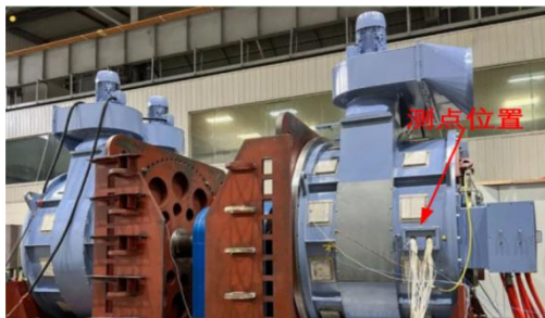
图 6 发电机上加速度传感器测点位置
