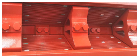
图7 极间表面粘贴的热敏纸
