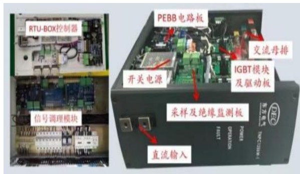
图11 配电末端电压柔性补偿装置实验平台
