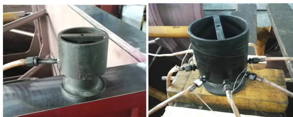
图8 水连通水平测量工具(左: 测量杯 右: 灌水杯)
