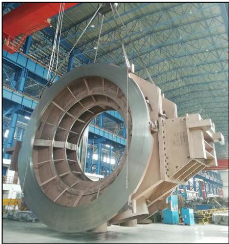
图3 合缸状态的低压内缸
