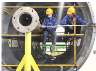
图9 以机座端面找测量中心柱中心
