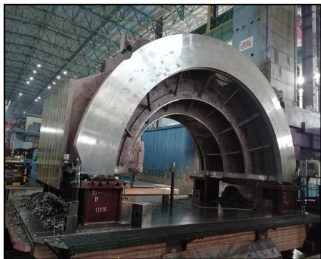
图7 精加工低压内缸下半纵向接配面
