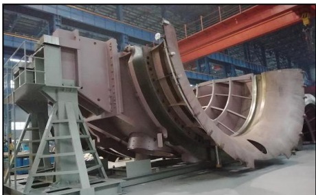
图4 与导流环接配后的低压内缸下半
