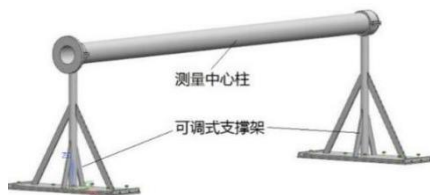
图1 卧式配装挡风板专用工具示意图
