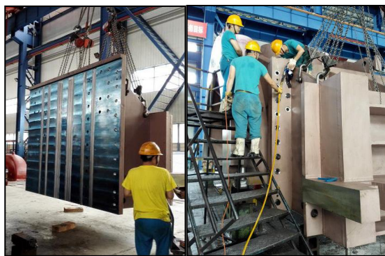
图8 支撑装置与低压内缸下半接配
