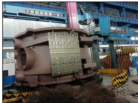
图6 低压内缸精车
