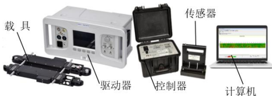
图 2 定子槽楔紧量检测设备
