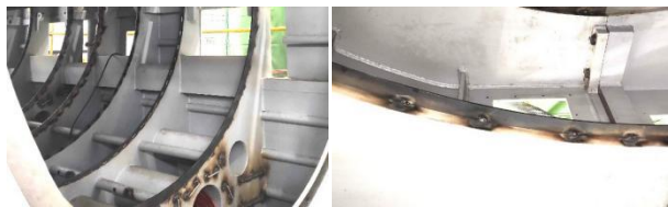
图10 配装及点焊后的挡风板示意图
