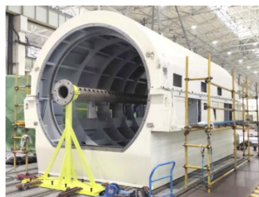
图8 布置机座、专用工具示意图
