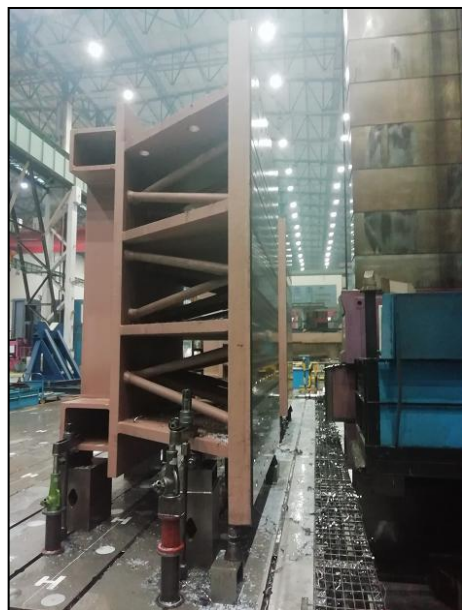
图5 精加工支撑装置纵向接配面
