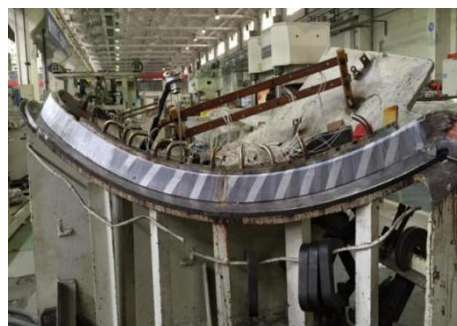
图 2 调相机定子线圈导线服帖模具
