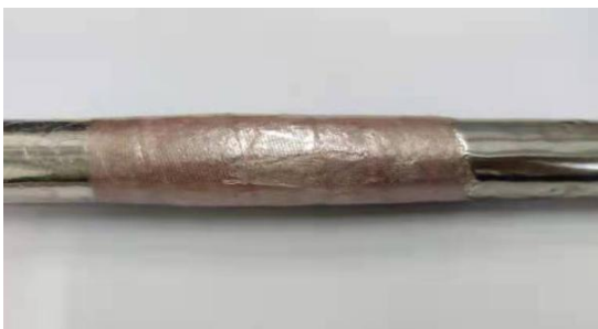
图 3 紫外光固化主绝缘试样
